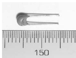
**Рис. 4.12.** Керамический конденсатор емкостью 0,1 мкФ
