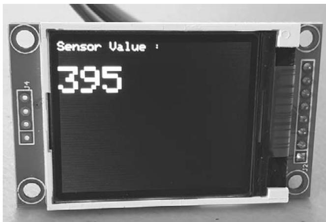
Рис. 9.11. Вывод значения с аналогового входа на экран ЖКИ
