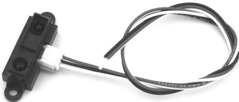
Рис. 14.24. ИК-датчик Sharp
