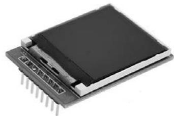
**Рис. 9.8.** Графический ЖКИ
