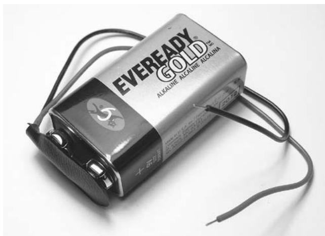
**Рис. 13.9.** Батарея 9 В и разъем для ее подключения
