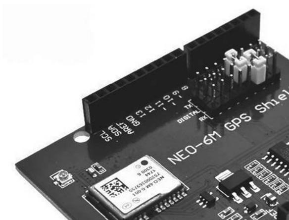
**Рис. 15.2.** Плата расширения GPS для Arduino
