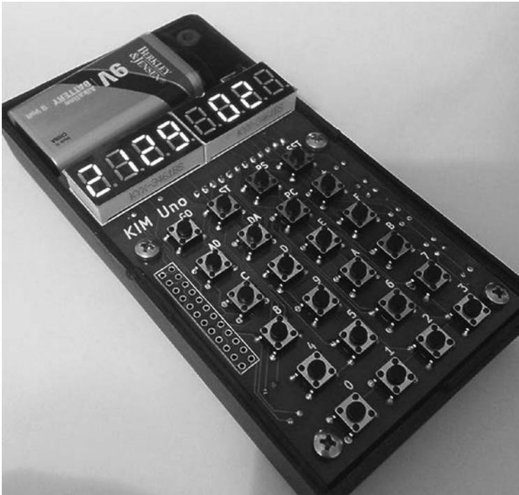
**Рис. 1.3.** Эмулятор компьютера KIM-1 на Arduino
