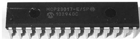
Рис. 19.7. Расширитель порта Microchip Technology MCP23017
