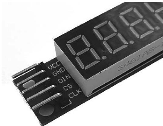
**Рис. 8.4.** Колодка с контактами на восьмиразрядном цифровом табло
