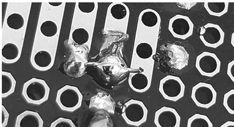
**Рис. 7.11.** Соединение контактов каплей припоя
