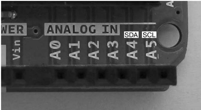
**Рис. 19.1.** Контакты на плате Arduino Uno, служащие одновременно выводами шины I<sup>2</sup>C
