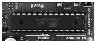
**Рис. 13.13.** Правильная ориентация микроконтроллера на плате Arduino
