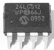
**Рис. 19.4.** Микросхема EEPROM Microchip Technology 24LC512
