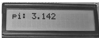
**Рис. 9.4.** Отображение значения вещественной переменной на экран ЖКИ
