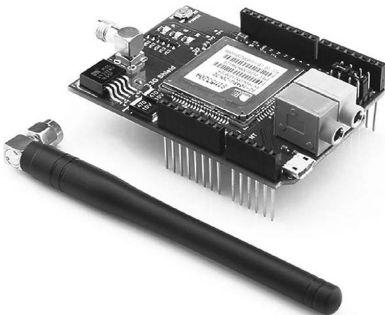
**Рис. 22.1.** Плата расширения GSM с подключаемой антенной
