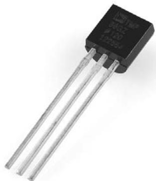
Рис. 4.40. Температурный датчик TMP36
