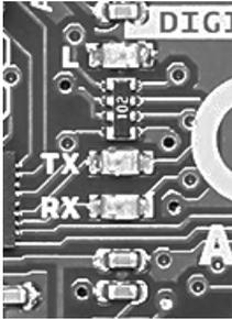
Рис. 2.6. Светодиоды на плате
